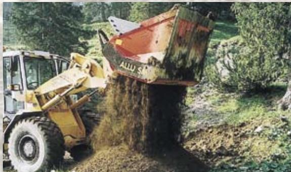
1. Просеивание торфа, с целью очистки его от корней.
