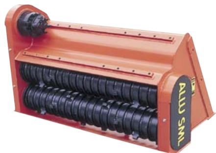
SML-серия спроектирована в облегченном варианте, для использования её на лёгких базовых машинах.
