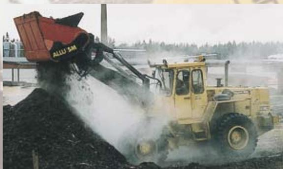
2. Проветривание компоста (ускоряет процесс компостирования).
