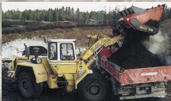
4. Одновременное просеивание и загрузка в транспортное средство компоста или грунта.
