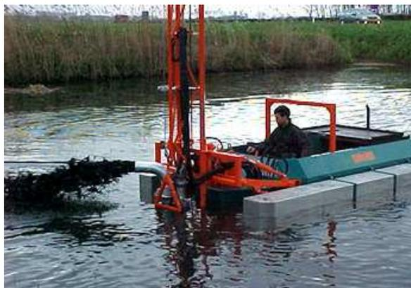
*Рис. Установка с металлическим понтоном и оператором добычной установки*
