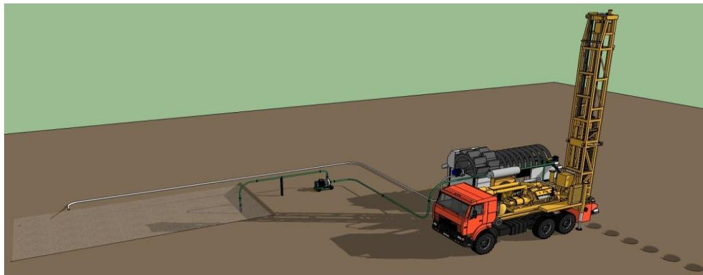
Способ добычи гагата – скважинный, большого диаметра бурения (800 мм) по специальной сетке. Максимальная глубина вскрытия россыпного месторождения – до 15 м. Обслуживается установка 2 специалистами. Все оборудование российского производства.
