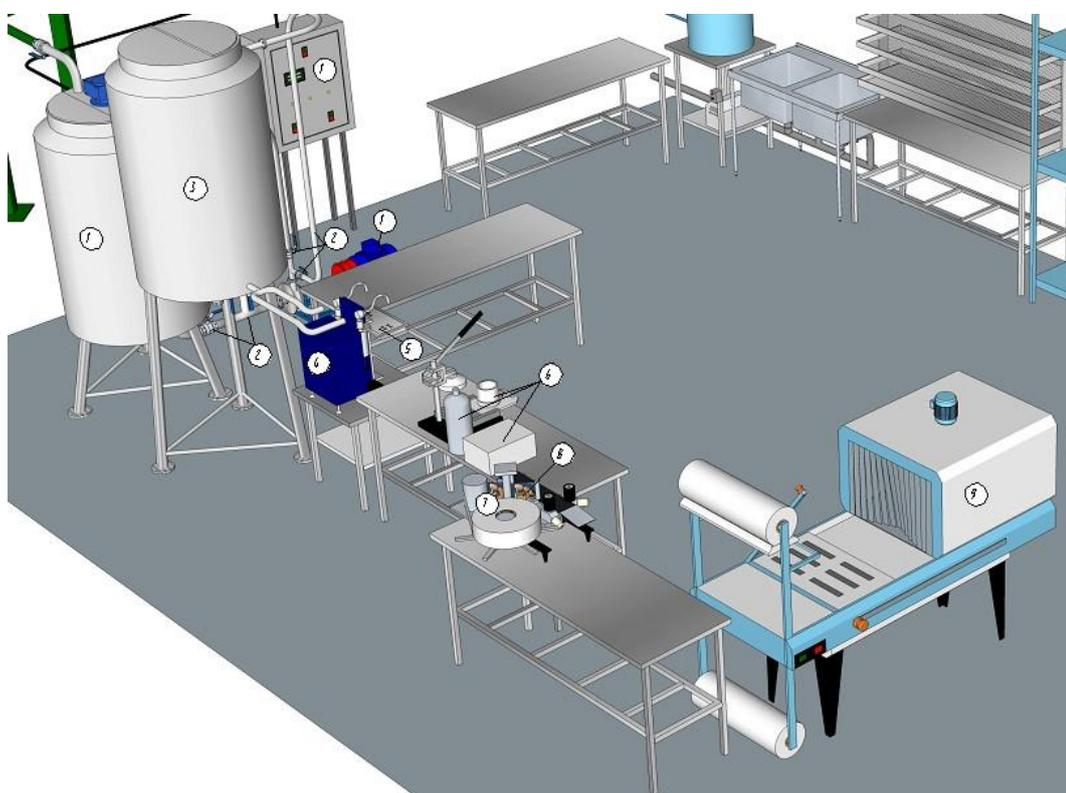
Такое оборудование позволит производить до 3 м<sup>3</sup>/час сыпучих и мелкогранулированных удобрений и до 1 м<sup>3</sup> таблетированных удобрений.
