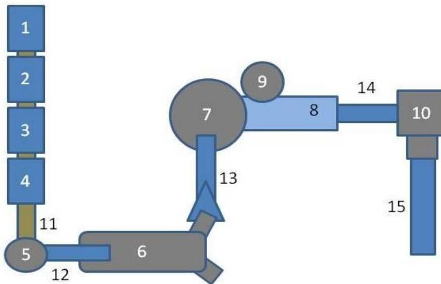
1,2,3,4. Загрузочные бункеры для сырьевых компонентов, 5. Измельчитель торфа и других компонентов, 6. Вибрационный грохот, 7. Накопительный бункер 8. Двухвальный смеситель, 9. Емкость для жидких компонентов. 10. Пресс для пакетирования торфа и субстратов на его основе, 11. Горизонтальный транспортер с дозаторами компонентов, 12. Ленточный наклонный транспортер, 13. Ленточный наклонный транспортер. 14 Наклонный транспортер, 15. Горизонтальный рольганг для упакованного в биг бэйлы торфа.
