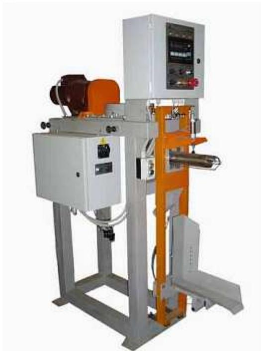
Управление полуавтоматом электропневматическое, основанное на преобразовании сигналов, поступающих с пульта управления и тензометрического датчика.
