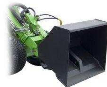
Ковши с увеличенной высотой выгрузки - правильный выбор, когда необходимо достать выше или дальше по горизонтали. Ковши оснащены собственным гидравлическим цилиндром, который наклоняет (опрокидывает) ковш относительно своего переднего края, что значительно увеличивает высоту разгрузки по сравнению с обычными ковшами. Идеальное навесное оборудование для загрузки прицепов, смесителей или бункеров фасовочного оборудования
