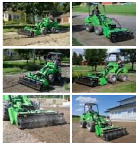
сеялкой - готовая газонная поверхность за один проход
