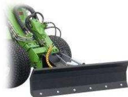
В стандартной комплектации оснащен съемным двухсторонним металлическим ножом с прямыми кромками. Пружинящий механизм предназначен для обеспечения большей безопасности во время проведения работ обслуживающим персоналом.
