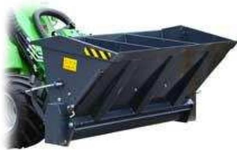
Разбрасыватель оборудован приводным гидромотором, рабочим валом и рыхлителем, который измельчает замерзший сапропель и предотвращает закупорку. Рабочий вал оснащен пружинными пластинами, чтобы куски материала не заблокировали или не повредили разбрасыватель.
