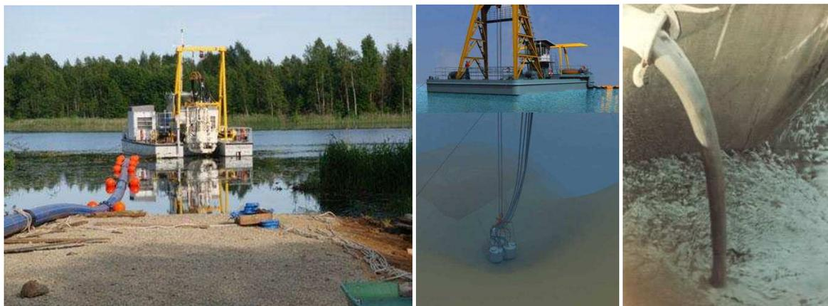
При удаленности промплощадки обезвоживания ила от места его извлечения применяется бустерная перекачивающая станция. При ее использовании трубопровод подачи илов может быть достигать до 2500-3000 м.
