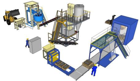
В зависимости от типоразмера смесителя производительность линии может достигать до  $10 \, \mathrm{m}^3/\mathrm{чаc}$ . Технология фасовки капсульного почвообразователя соответствует евростандарту и позволяет хранить его на складе втечение двух недель, транспортировать на расстояния и укладывать на месте использования как в ручную так и механизированным способом.
