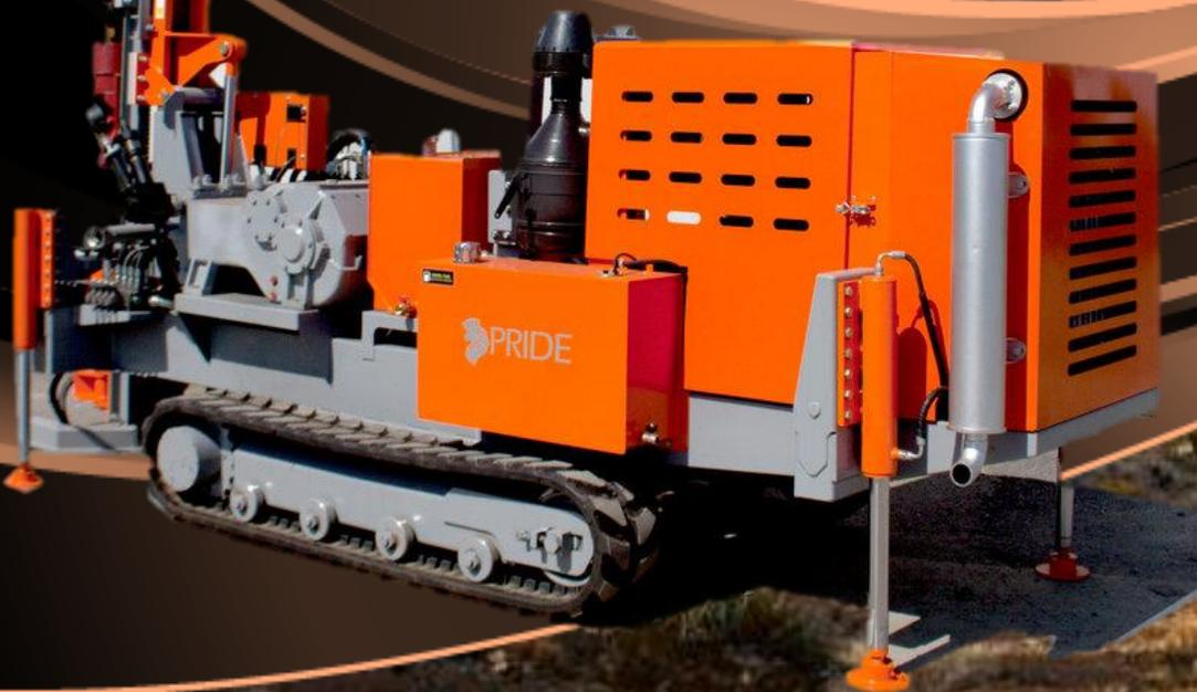
Установка представляет собой передвижной самоходно-гусеничный комплекс с прицепным к внедорожнику, вездеходу или трактору вспомогательным насосно-компрессорным оборудованием и промывочно-обогащительным агрегатом, набором инструментов, шлангов, обсадных труб, материалов для проходки и эксплуатации технологических скважин глубиной до 30-40 м.
