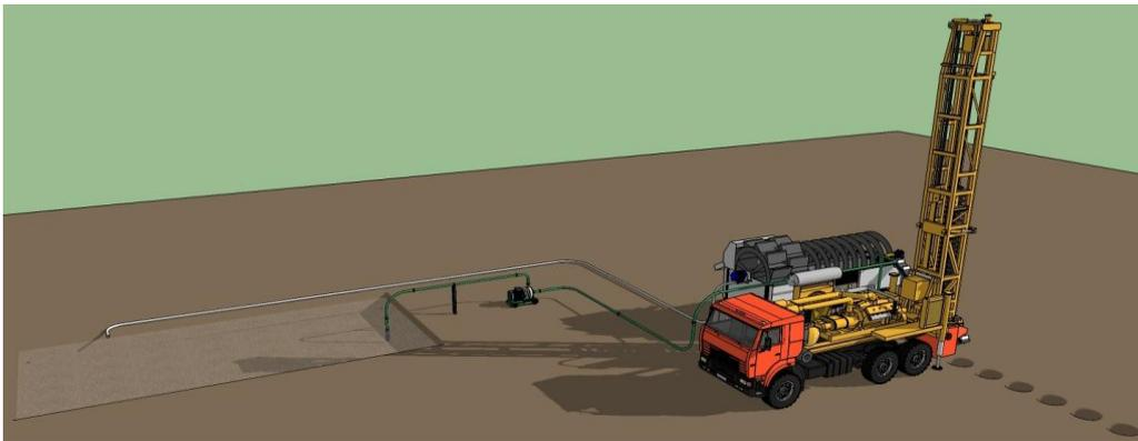
Способ добычи янтаря – скважинный, большого диаметра бурения (800 мм) по специальной сетке. Максимальная глубина вскрытия россыпного месторождения – до 15 м. Обслуживается установка 2 специалистами. Все оборудование российского производства.
