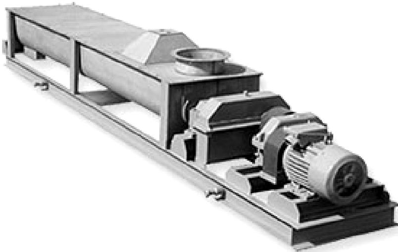
Смеситель представляет собой стационарную установку и состоит из основных узлов: рамы, корпуса, валов с лопатками, привода. Такие смесители позволяют равномерно смешивать от 30 грамм одного из компонентов с тонной основного вещества при производительности от 6 до 50 т/ч. То есть смесители обеспечивают равномерное смешивание компонентов в соотношении 1:30000. Основные параметры
