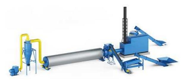
Сушильные комплексы барабанного типа зарекомендовали себя как надѐжные и отказоустойчивые решения. Благодаря прямому контакту сушильного агента с сырьѐм, достигается высокий тепловой КПД и высокий процент снятия влаги, позволяющий просушивать даже сильновлажное сырьѐ. За счѐт усиленного перемешивания материала внутри барабана достигается равномерный нагрев всех частиц.
