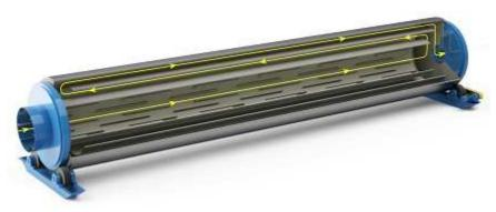
Из барабана высушенное сырьè поступает по воздуховоду в циклон-осадитель, из которого сырьè поступает в молотковую дробилку ДКР.
