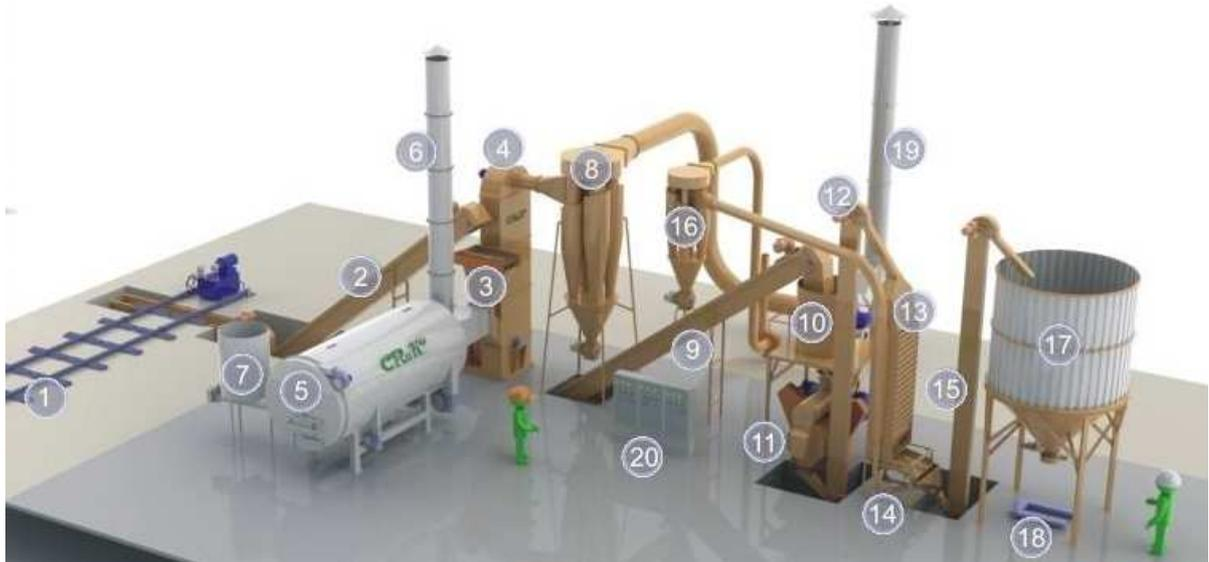
Завод по производству гранулированных кормов из сапропеля и травы. Основан на Агрегате сушки-измельчения АС-4-1500. Измельчение и высушивание сапропеле-травяной смеси происходит за 2 ... 3 секунды, что обеспечивает максимальную сохранность витаминов.
