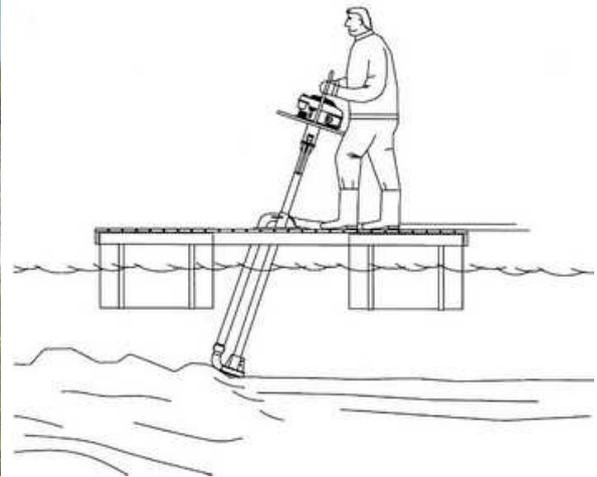
Земснаряд МZ-60 предназначен для дноуглубительных, очистительных работ в каналах, озерах на глубине до 2,5 м., специальный зубчатый венец расположенный возле всасывающей трубы позволяет применять агрегат для измельчения водорослей и камыша. При необходимости комплектуется всасывающим элементом длиной 1,4 м.
