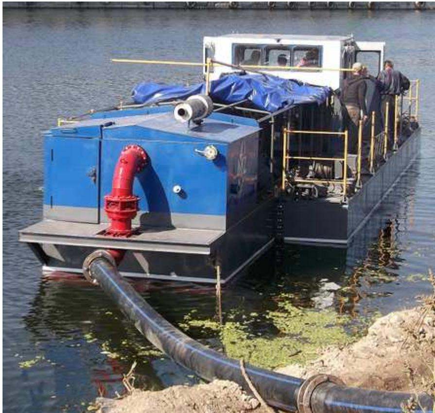
с глубиной разработки до 10 метров. Так как земснаряд был сделан на базе земснаряда MZ-800/40 и за счет применения новых агрегатов, а именно, адаптированного агрегата с водным охлаждением, производительность по добыче увеличена до 1200 м<sup>3</sup>/час по пульпе .
